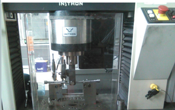
Stanowisko prostowania próbek przez zginanie
