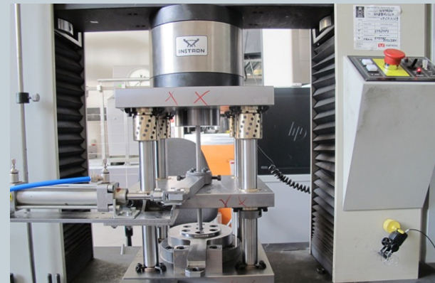
Stanowisko do rozciągania ze skręcaniem w środku oraz przeginaniami w środku
