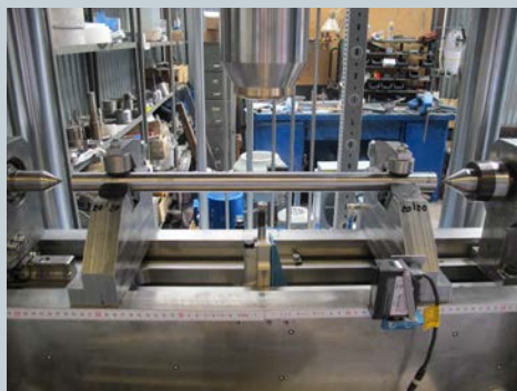
Przygotowanie pręta do gięcia/prostowania (etap 3.)
