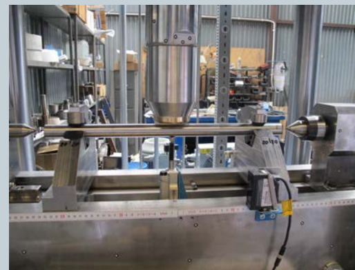
Gięcie/prostowanie pręta (etap 3.)
